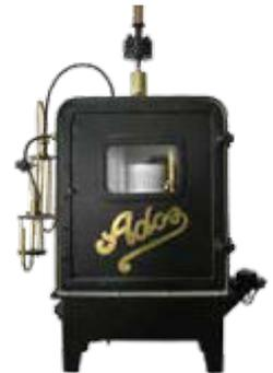
In einem Kardangelenk hängendes Messgerät (zwecks Ausgleich der starken Wellenbewegungen) zur Kohlendioxidmessung auf Schiffen.
