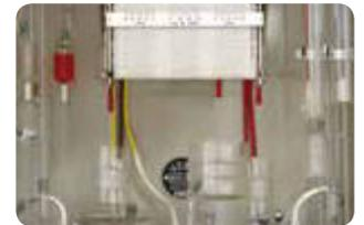
3-fach Messgerät (Triplex) zur Überwachung des CO-, H<sub>2</sub>- und CO<sub>2</sub>-Gehaltes in der Umgebungsluft – Einsatz in der chemischen Industrie.
