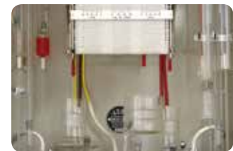
3-fach Messgerät (Triplex) zur Überwachung des CO-, H 2 - und CO 2 -Gehaltes in der Umgebungsluft – Einsatz in der chemischen Industrie.
