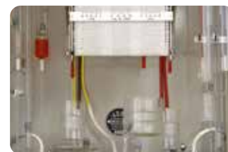
3-fach Messgerät (Triplex) zur Überwachung des CO-, H 2 - und CO 2 -Gehaltes in der Umgebungsluft – Einsatz in der chemischen Industrie.
