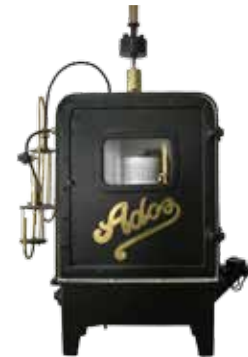
In einem Kardangelenk hängendes Messgerät (zwecks Ausgleich der starken Wellenbewegungen) zur Kohlendioxydmessung auf Schiffen.
