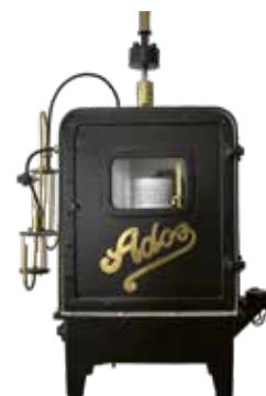
In einem Kardangelenk hängendes Messgerät (zwecks Ausgleich der starken Wellenbewegungen) zur Kohlendioxydmessung auf Schiffen.
