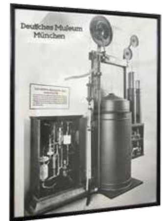
Erster selbsttätiger Rauchgasprüfer "ADOS" aus dem Jahre 1900. Durch den Kaminzug angetrieben, nimmt das Gerät 10mal pro Stunde eine Probe des Rauchgases, analysiert es automatisch und zeichnet seinen Kohlensäuregehalt auf. Dieser bildet den Maßstab für die wirtschaftlichste Brennstoff-Ausnutzung durch das Heizer-Personal. Sie liegt bei 15% Kohlensäure-Gehalt in den Feuergasen.
