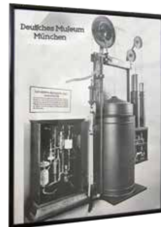
Erster selbsttätiger Rauchgasprüfer "ADOS" aus dem Jahre 1900. Durch den Kaminzug angetrieben, nimmt das Gerät 10mal pro Stunde eine Probe des Rauchgases, analysiert es automatisch und zeichnet seinen Kohlensäuregehalt auf. Dieser bildet den Maßstab für die wirtschaftlichste Brennstoff-Ausnutzung durch das Heizer-Personal. Sie liegt bei 15% Kohlensäure-Gehalt in den Feuergasen.
