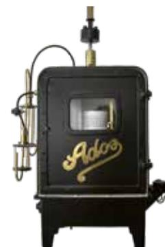
Appareil de mesure en suspension dans une articulation à cardan (pour compenser les forts mouvements de l'arbre) et permettant la mesure du dioxyde de carbone sur les bateaux.
