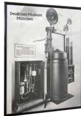
Entraîné par le tirage de la cheminée, l'appareil prélève un échantillon des gaz de fumée 10 fois par heure, l'analyse automatiquement et enregistre la teneur en dioxyde de carbone. Cette teneur constitue la valeur de référence qui indique si l'utilisation la plus rentable du combustible est atteinte par les chauffeurs de chaudières. Celle-ci est réalisée à une teneur de 15% en dioxyde de carbone dans les gaz de chauffage.
