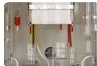
Appareil de mesure triple (Triplex) pour la surveillance de la teneur en CO, H<sub>2</sub> et CO<sub>2</sub> de l'air ambiant – utilisation dans l'industrie chimique.
